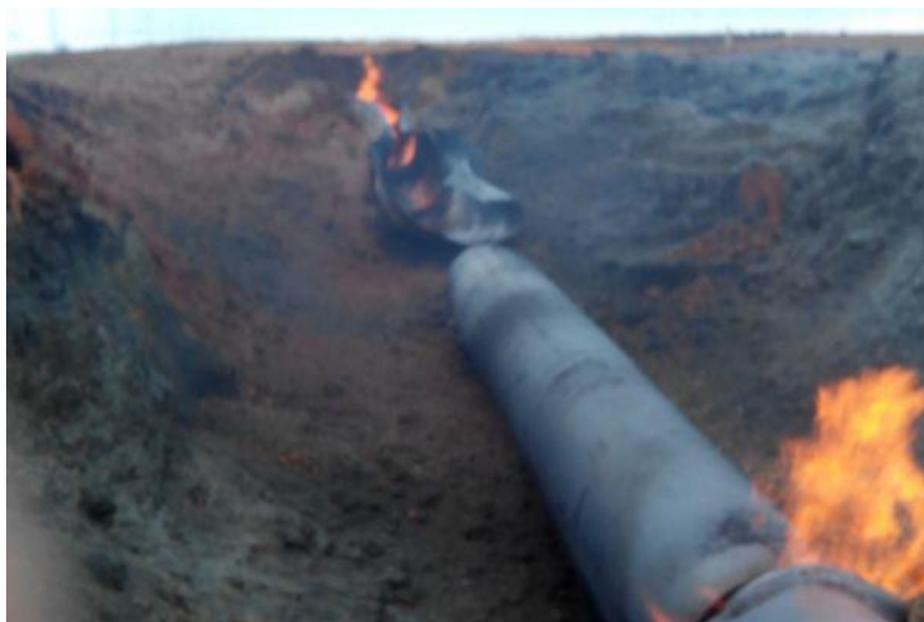
Рисунок 1.21 - Разрыв с возгоранием на участке 283 км магистрального газопровода "Оренбург-Новопокров" "
